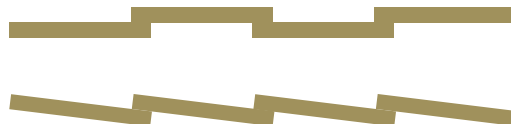
Bei der Befestigung des Streifenvorhangs ist die Anordnung «eins ums andere» (oben) der «immer drauf» (unten) vorzuziehen.
